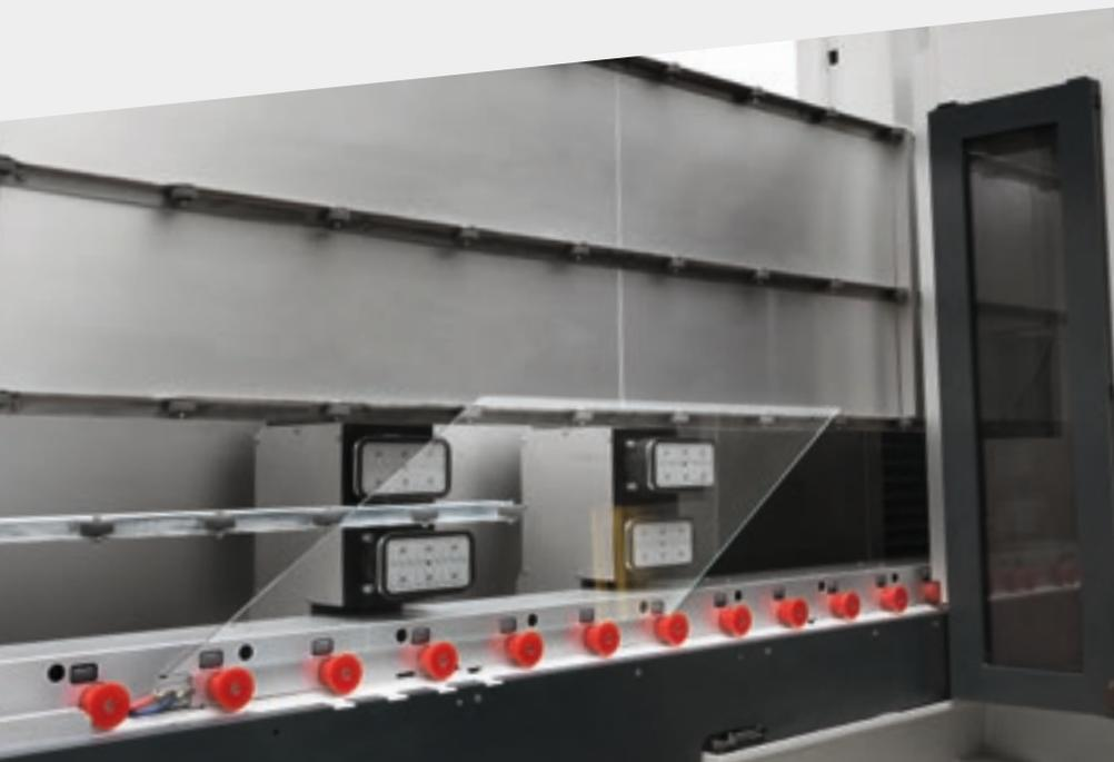
Il sistema di riposizionamento dinamico dei carri ventose (brevettato) è pensato per processare un pezzo senza mai lasciarlo tra un posizionamento del carro ventose ed il successivo.
